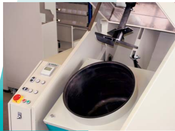
Mischtrommel offen zur Befüllung Mixing drum ready for charging
